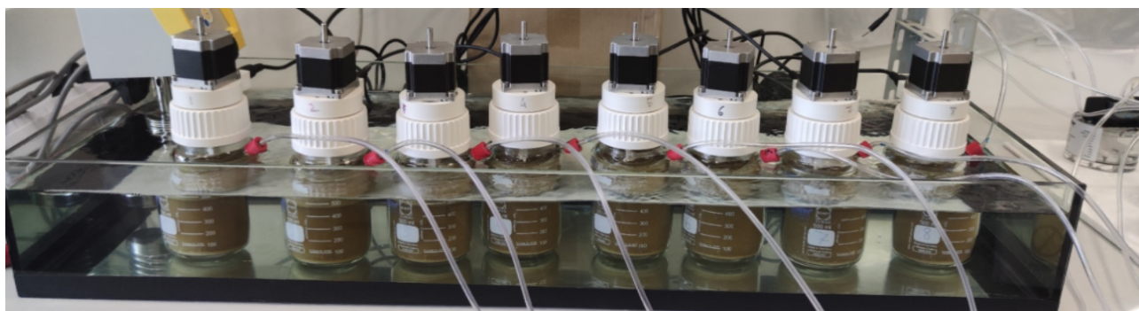
Figura 7. Sistema di fermentazione ruminale in vitro sviluppato dal gruppo di ricerca in Nutrizione e alimentazione animale dell'Università di Udine.
